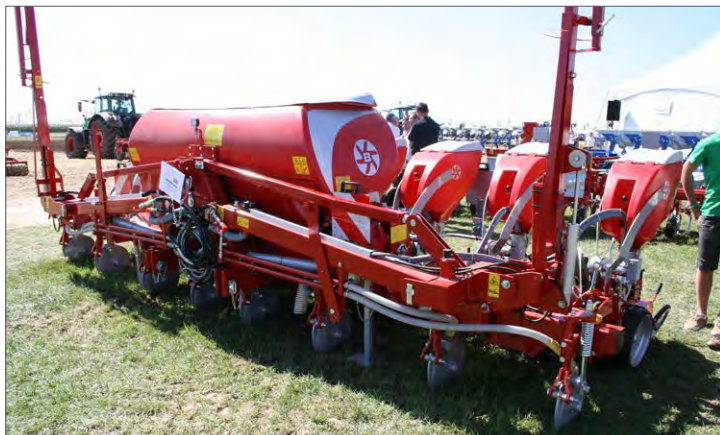
Kongskilde visade upp nya precisionssåmaskinen Becker Aeromat Advance. Den har en gödningslåda på 1200 liter och skivbillar för gödningsmullning under såraden.
