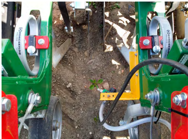
uftassisterat AirTech-munstycke monterat på radrensaraggregatet och vinklat för att uppnå 12 cm appliceringsbredd.
