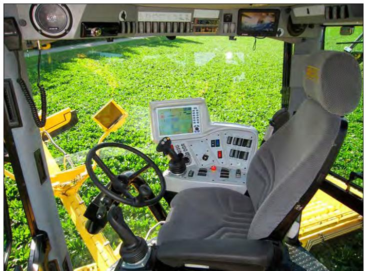
Hytten på Ropa Maus 4 kan höjas och sänkas med hydraulik och föraren har full kontroll med många automatiska funktioner som gör arbetet exakt och enkelt.
