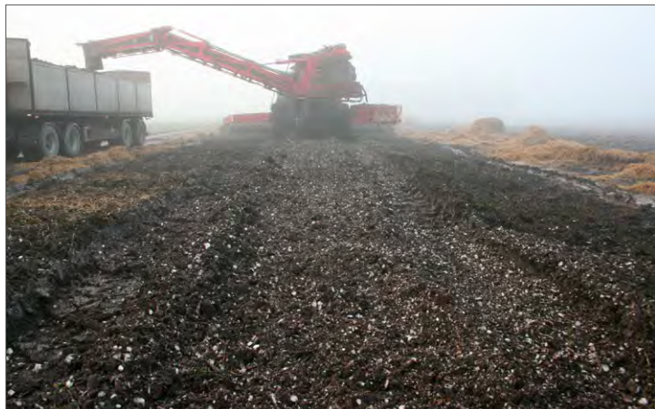
Det är en skonsammare behandling av marken när man kör med renslastare i stället för med hjullastare, men stukan behöver placeras nära farbar mark för att de högst femton meterna från bethögens mitt till flakets centrum ska räckta till.
