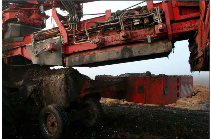
Rensverket VarioCleaner kan köpas med tolv rullar, varav två är av stål för att skilja bort sten. Vid rena betor kan en matta skjutas in för att täcka hälften eller alla rullar i rensverket.
