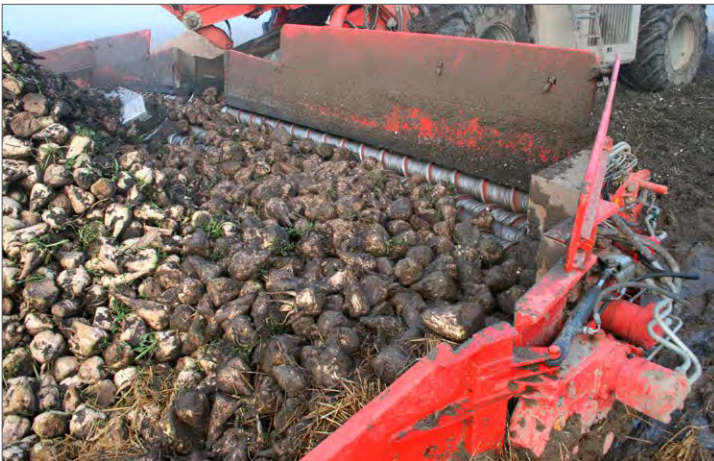
Bordet har åtta rullar och mäter som standard 9,8 meter. Södra Sandby Maskinstation har själv breddat sitt bord med 45 cm på varje sida för att klara bredare stukor. Till 2016 kommer Holmer med justerbar vinkel på bordet som standard.
