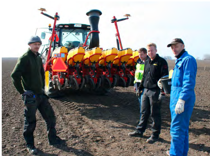
Tester från 2014 och tidigare har visat att fröet varierar cirka två centimeter i sidled med Tempos standardskivbill. I år gör man försök med en sexradig maskin där hälften av aggregaten har den vanliga skivbillen medan hälften har den nya fasta billen.
