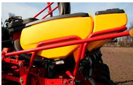
På den nya billen blåses fröet ut genom ett hål i billens bakkant och stoppas och trycks till av stopphjulet.
