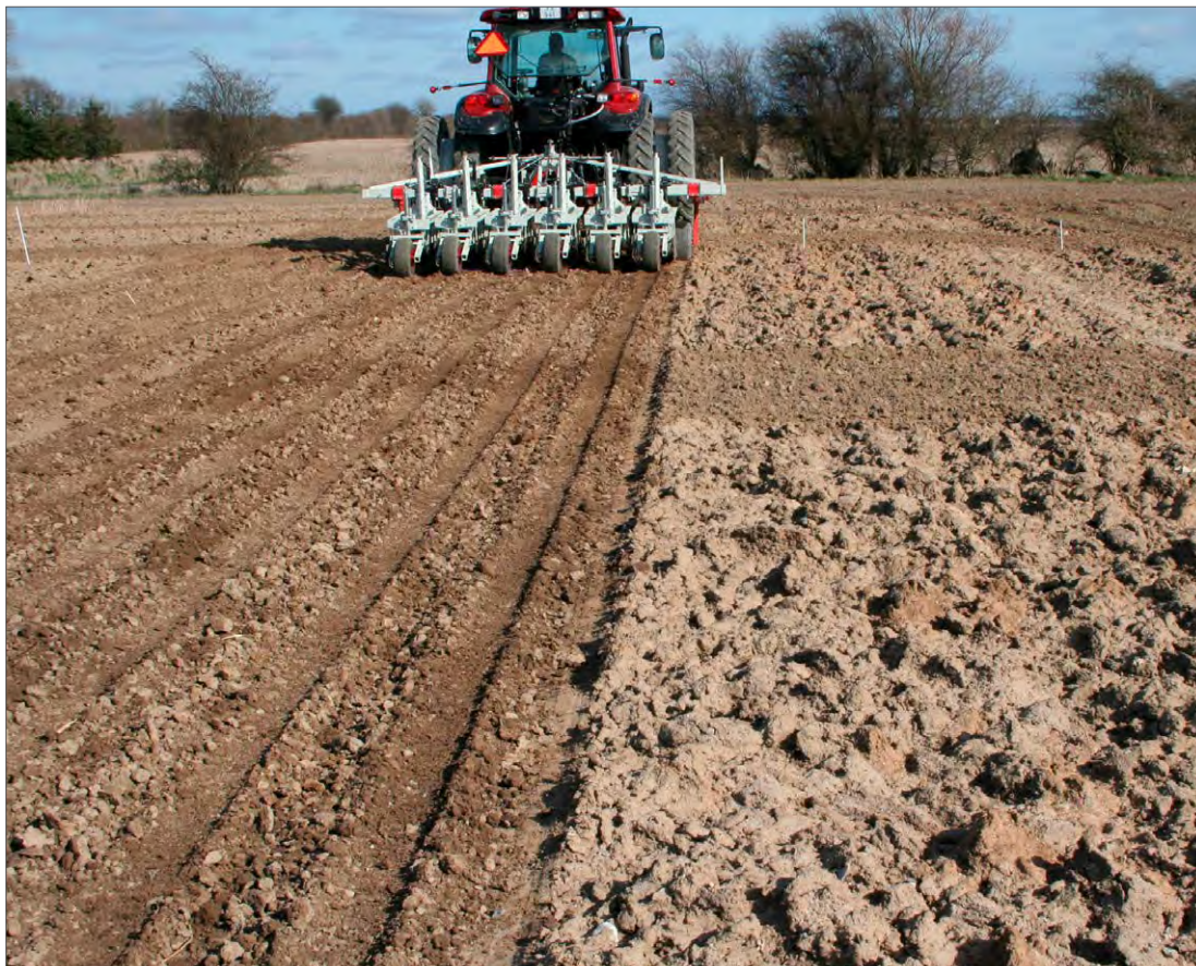
Här görs sabbädden med en specialkonstruerad harv, som endast bearbetar jorden i raderna.
