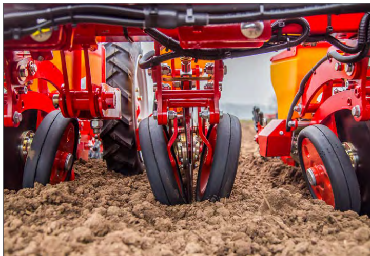
De tvärställda skivorna framför såbilden underlättar mycket. Med dessa uppnås en jämn och säker fröplacering i varierande såbruk.
