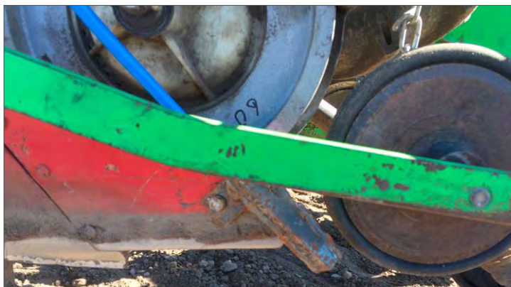
En enkel bill är monterad på utsidan av skyddsplåten efter såbilen. P tillförs i 150 l vatten per hektar.
