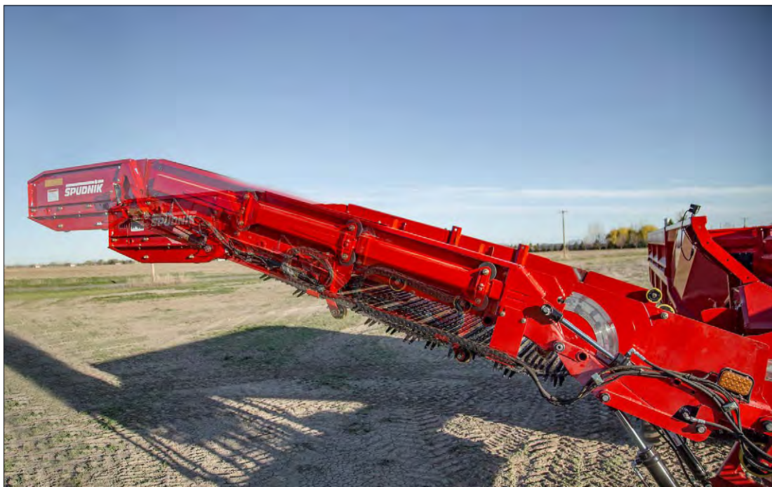
Hydraulisk in- och utfällning. Elevatorn fälls in och ut hydrauliskt och mattan byts till en gummiduk om man kör spannmål.
