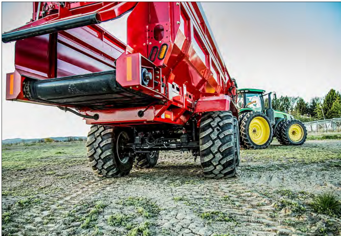
Helt tät. Vagnen är helt tät och kan därmed även användas till spannmål och liknande.
