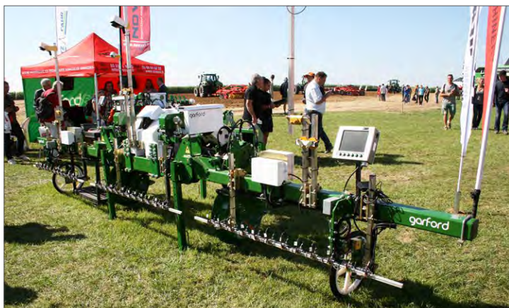
Garford Robocrop SpotSprayer är en punktbehandlingsspruta för radgrödor. Reduceringen av preparatkostnad kan vara hela 98 procent i vissa fall.
