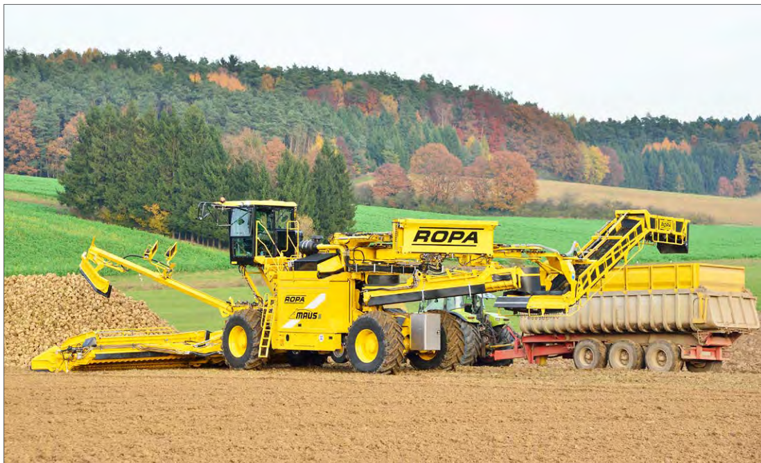
Maus 5 har rensteknik från tidigare modell, men har nu den nya hytten R-Cab och 10,2 meter brett lastarbord
