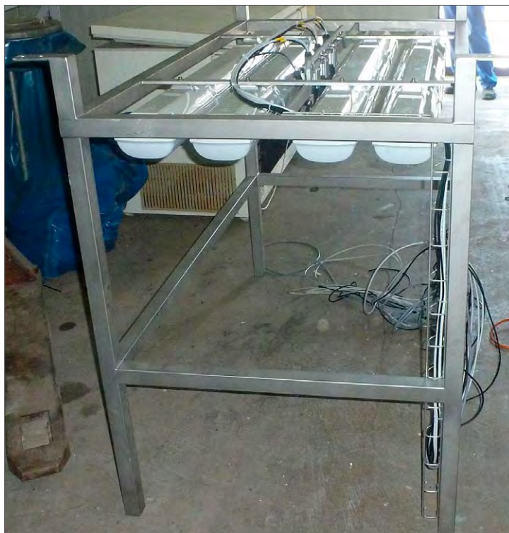
Nytt kamerasystem för reglering av efternackning. (Bilden är från Sockerbruket i Lage.)
