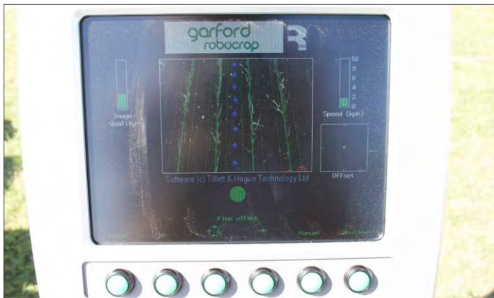
I datorn ställer man in aggressivitet, det vill säga hur stor del av ogräset som ska besprutas och hur nära raderna den får behandla. Ogräset ringas in med röda ringar.
