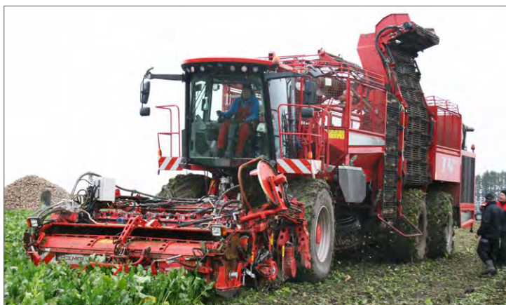
Holmer T4-40 har en funktion där föraren med hjälp av datorn, grovt kan felsöka maskinen för att snabbare komma igång igen vid ett eventuellt stillestånd.
