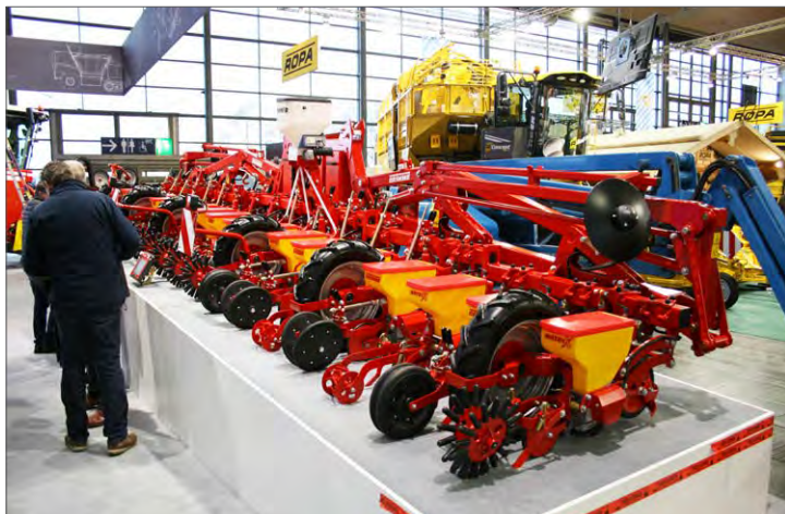
Matrix från Grimme finns med 12 eller 18 rader och har elektrisk drivning av cellhjulen. Det gör att man kan öka antalet utsädesenheter i raderna bredvid ett körspår för att kompensera för mindre plantor.
