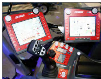
Grimmes ErgoDrive är namnet på armstödet med joystick med scrollhjul och dubbla pekskärmar för enklast möjliga inställning och övervakning.
