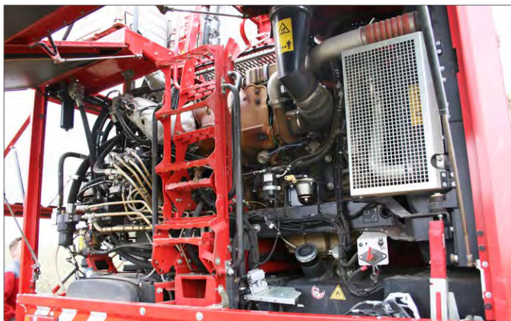
Holmer T4-40 har en motor från Mercedes-Benz på 620 hästkrafter. Vid normalt arbete ligger den på 1100-1200 rpm.
