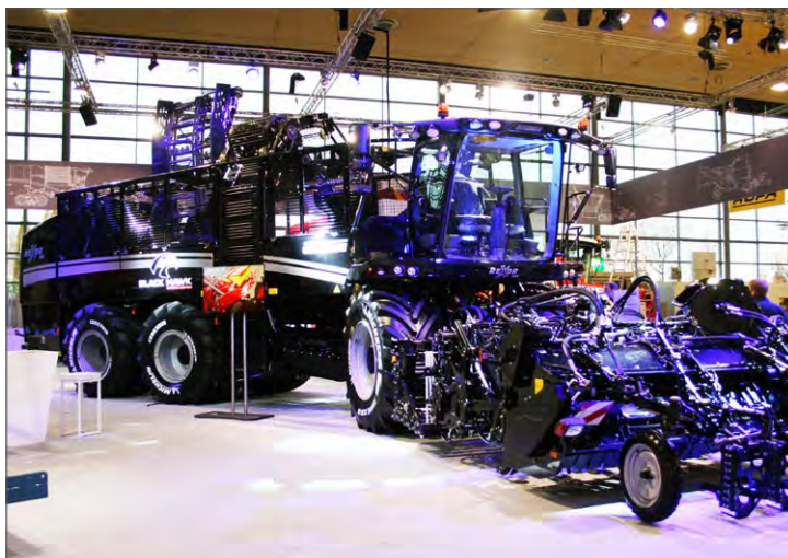
Grimme Rexor 630 har fått en ny kombiblastare där föraren kan ställa om mellan sidoutkast och inline-nedsläpp av blasten från hytten. Som standard framöver blir belysning av Led-typ.
