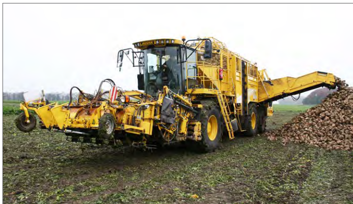
Ropa Tiger V8-4 har nackningssystemet MicroTopper. Då slår slagorna av blasten högre upp. Sedan kommer styrflingor som justerar kniven efter höjden på varje beta och därmed blir de toppade utan minimal.
