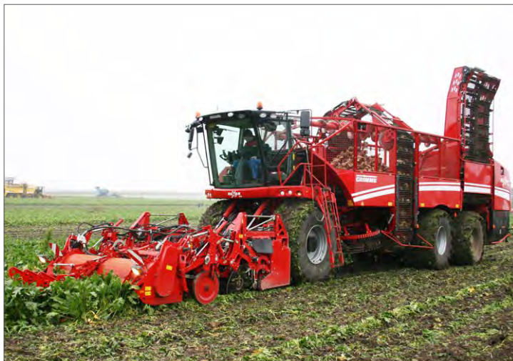
Grimme Rexor 630 har en tank på 45 kubik och kör fram på sex hjul. Rensningen görs med tre rouletter, som delvis består av vanlig grind, delvis av fjädrande pinnar.
