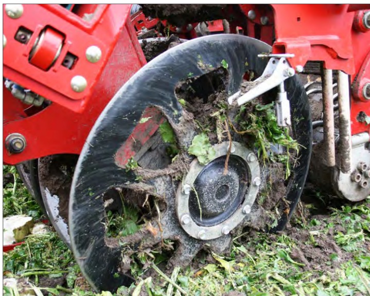
Grimme kör på hydrauliskt drivna oppelhjul på sina betupptagare. Det är en skonsam typ av upptagning, menar de.
