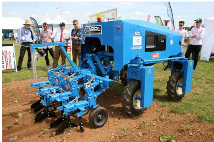
Fyrhjulsstyrning. För att inte behöva ha onödiga varningssystem körs aldrig Anatis baklänges i autonomt läge. I stället vänder den med fyrhjulsstyrning och jobbar sedan med krabbstyrning när den
