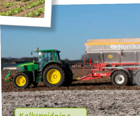
Kalkspridning med rörspridare.
