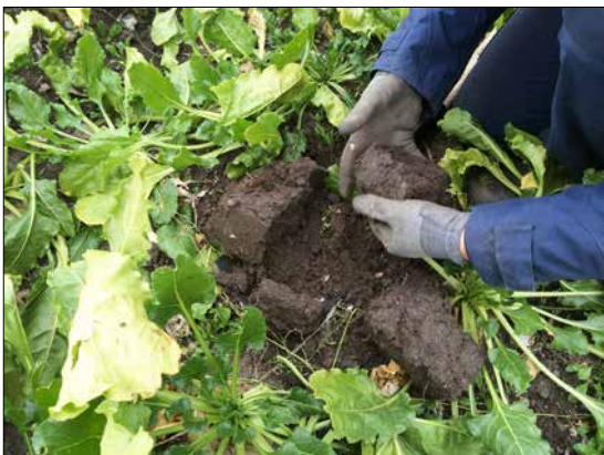
Jordklumpar för turbiditetsmätningar. Provtagning av aggregat i sockerbetor för turbiditetsmätning. Jordaggregat grävdes upp och transporterades till en regnsimulator på SLU i Uppsala för mätning av det avrinnande vattnets turbiditet (grumlighet) (figur 1).
