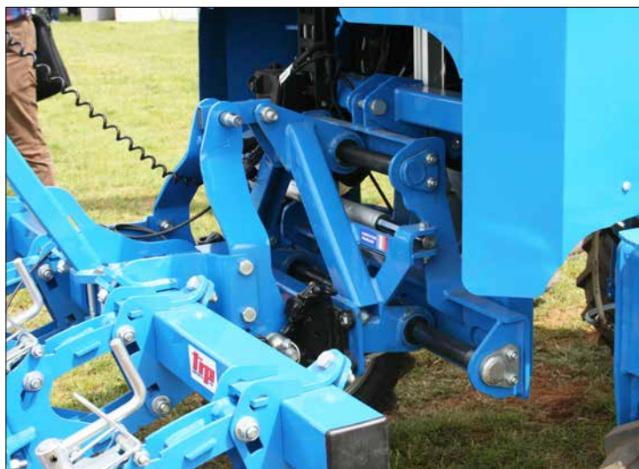
Skjuts i sidled. Trepunkten kan skjutas i sidled med bakgrund om den information som kameran för redskapsstyrning ger. Kamera och dator känns igen från flertalet andra kamerastyrda radhackor.
