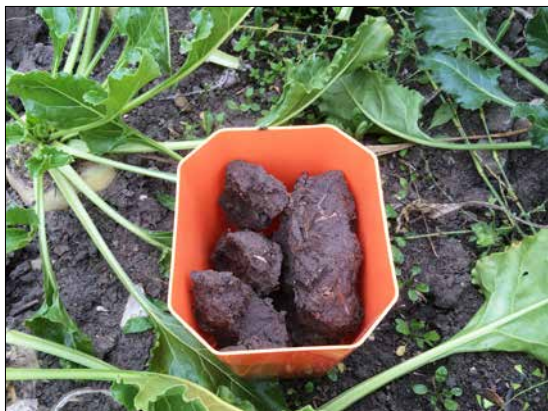
Jordklumpar för turbiditetsmätningar. Provtagning av aggregat i sockerbetor för turbiditetsmätning. Jordaggregat grävdes upp och transporterades till en regnsimulator på SLU i Uppsala för mätning av det avrinnande vattnets turbiditet (grumlighet) (figur 1).
