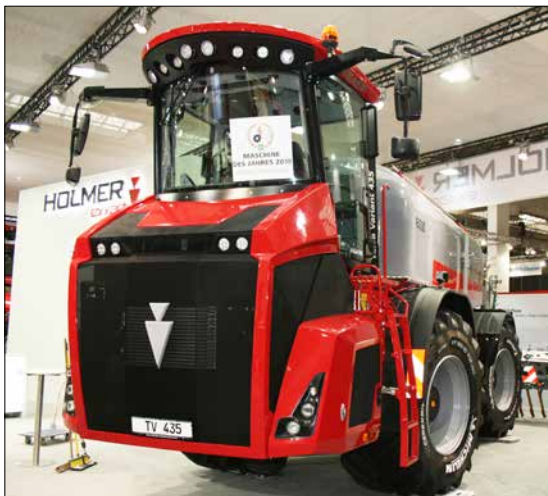
Terra Dos. Holmers redskapsbärare Terra Dos kan ha flera olika applikationer, här som självgående flytgödselspridare med ramp eller som till höger, tippflak för exempelvis fälttransport mellan betupptagare och stuka.
