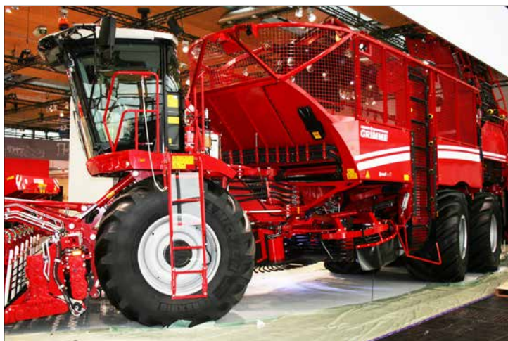
Vinklad elevator. Vinklad elevator innebär att maskinens tyngdpunkt flyttas närmre centrum av maskinen och gör den stabilare. Maskinen blir dessutom lägre.
