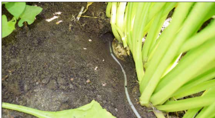
Temperaturmätning med logger som grävs ner i samband med sådd.
